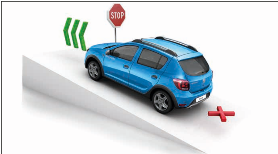
Berganfahrassistent: Diese Funktion unterstützt Sie wirkungsvoll beim Anfahren an einer Steigung, indem der Bremsdruck selbsttätig eine ausreichende Zeit gehalten wird.
