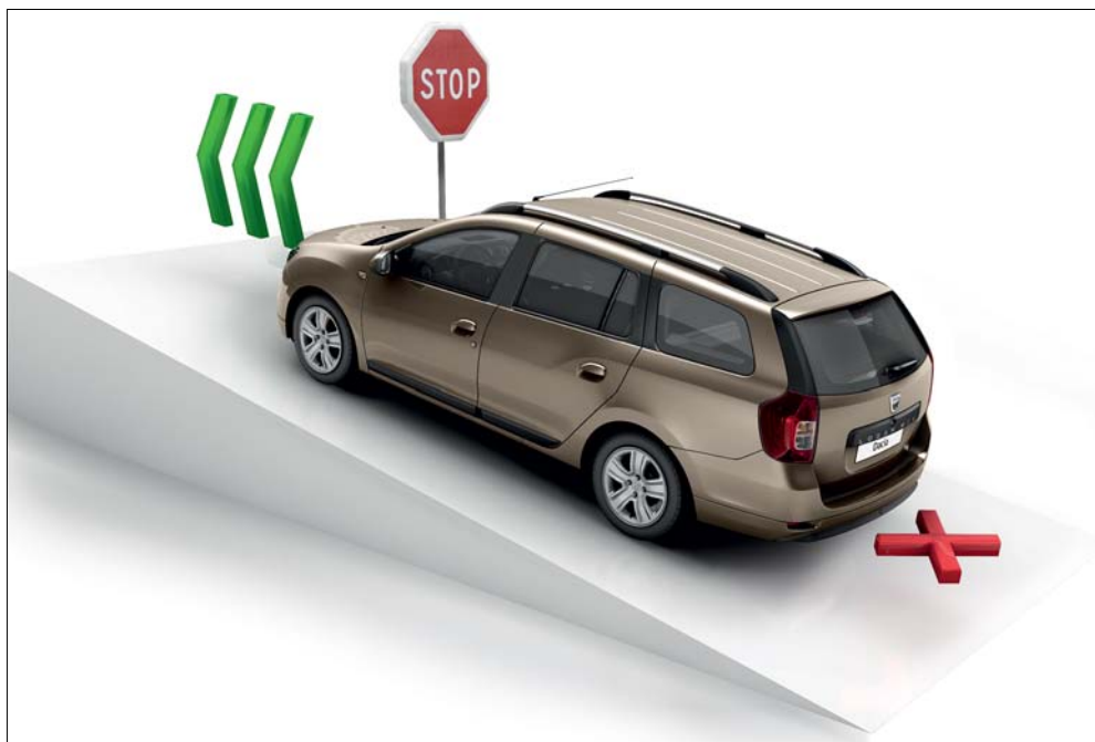
Подпомагане потеглянето по наклон: Тази система ви позволява да потеглите под наклон в пълна безопасност и без да бързате.
