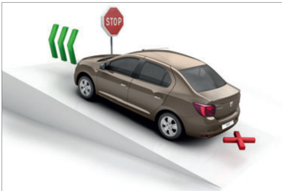
Asistent rozjezdu do kopce*: Systém napomáhající plynulému rozjezdu ve svahu bez nechtěného couvnutí.
