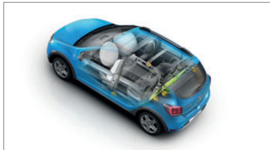
Ochrana: zesílená konstrukce karosérie, čelní a boční airbagy v přední řadě, úchyty dětských autosedaček Isofix na bočních zadních sedadlech.
