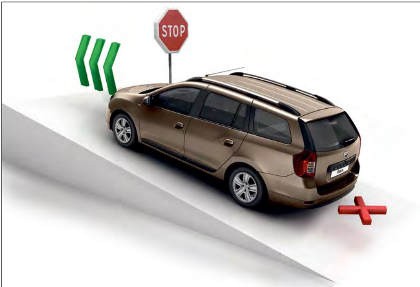
Mäkilähtöavustin: Järjestelmä mahdollistaa turvallisen liikkellelähdon mäessä, ilman tarvetta kiirehtiä.
