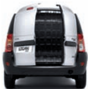
Takaovien avauskulmat (40°, 90° ja 180°) ja yhtenäinen väliseinä.
