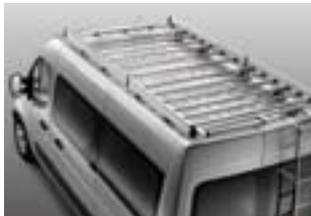
Matière aluminium validée en acoustique et parfaitement adaptée au NOUVEAU MASTER pour le maintien de l'étanchéité.
