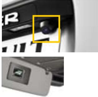
Permet de visualiser sur écran ce qui se passe à l'arrière du véhicule.
