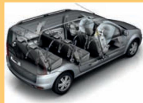
La sécurité des passagers est assurée par un ensemble complet d'airbags (airbags frontaux, latéraux thorax\*), et de ceintures avant et arrière 3 points à enrouler.
