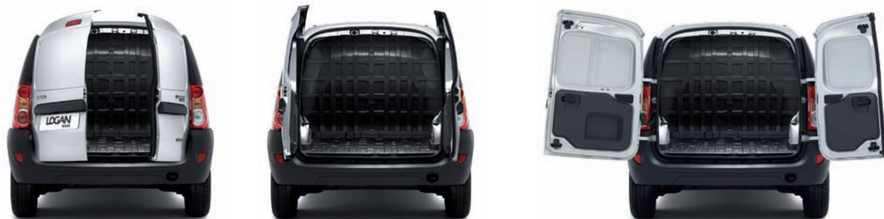
Angles d'ouverture des portes arrière (40°, 90° et 180°) et cloison complète*.
