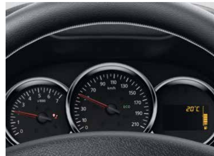
Neue Instrumente inkl. Bordcomputer mit Außentemperaturanzeige, Eco-Mode und Schaltpunktanzeige
