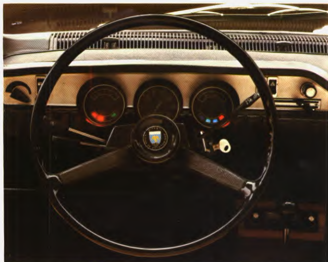
Dashbord van de 1300 de Luxe. Alle instrumenten in één oogopslag te overzien.
