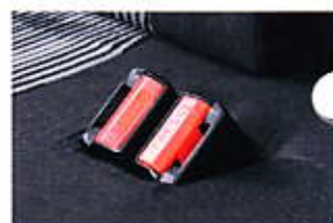
Nieuwe gespen voor de veiligheidsgordels op de 3 e zitrij voor de plaatsing van universele kinderzitjes
