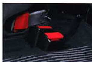
Isofix bevestigingssysteem voor kinderzitjes op de zijplaatsen van de 2 e zitrij
