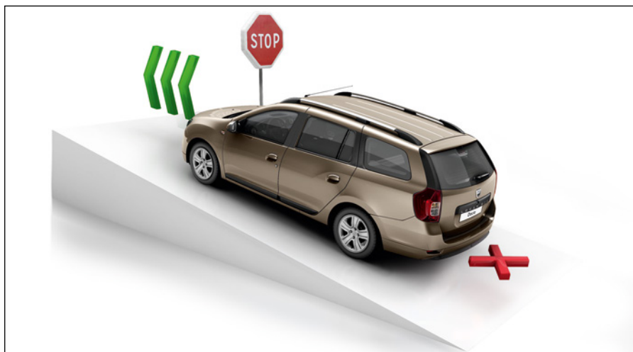
Wspomaganie ruszania pod górę: system ten umożliwia w pełni bezpieczne i niewymagające pośpiechu ruszanie pod górę.
