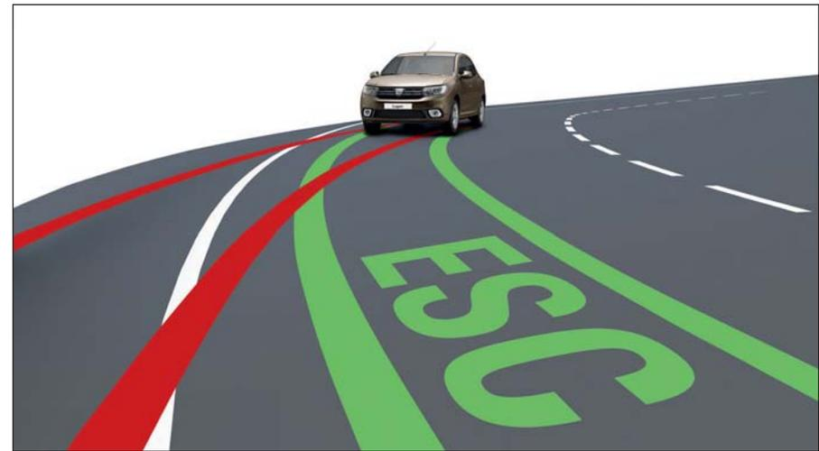
**Sistema de control de trayectoria ESP**: Permite controlar la estabilidad del vehículo en caso de pérdida de adherencia en las curvas, actuando sobre el reparto de la frenada y el régimen del motor.
