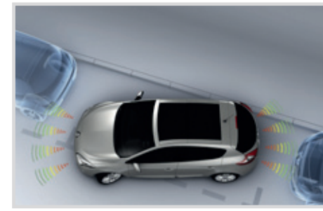
PARKERINGSSENSOR som gör föraren till expert på att fickparkera. Inbyggda sensorer ger genom en ljudsignal besked om avståndet till bakomvarande objekt. Paketnummer: Fram BS031, Bak BS030
