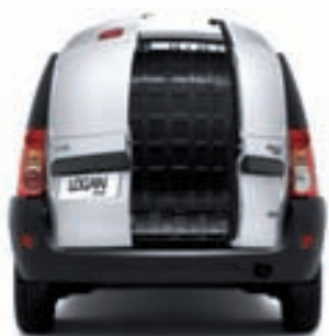
Bakdörrarnas öppningsvinkel (40°, 90° och 180°) och hel mellanvägg.
