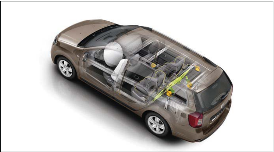
Insassenschutz: verstärkte Karosseriestruktur, Front- und Seitenairbags vorne, ISOFIX-Kindersitzverankerungssystem auf den hinteren Aussenplätzen.
