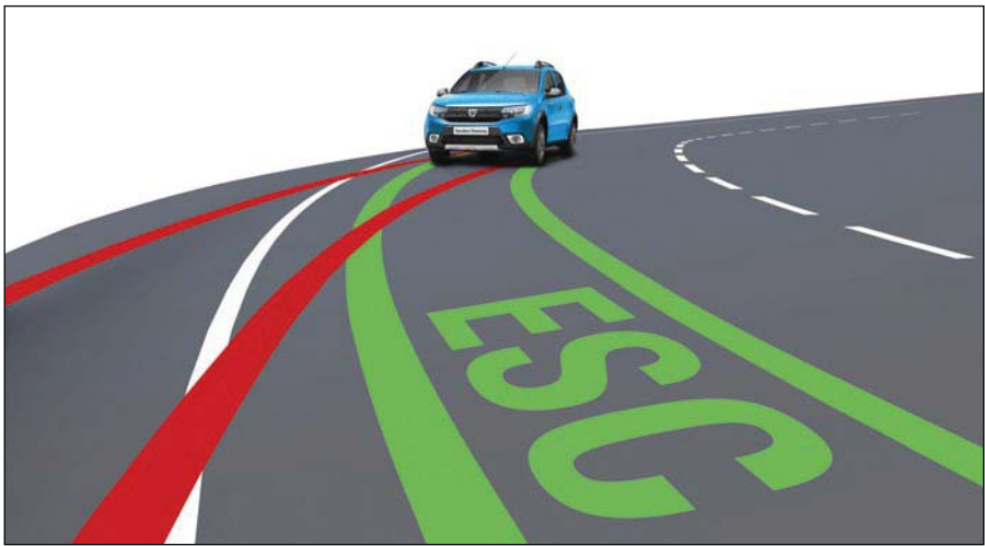
Elektronisches Stabilitätsprogramm (ESC): Das System hält das Fahrzeug bei verminderter Bodenhaftung in Kurven in der Fahrspur, indem es auf die Bremskraftverteilung und die Motordrehzahl Einfluss nimmt.
