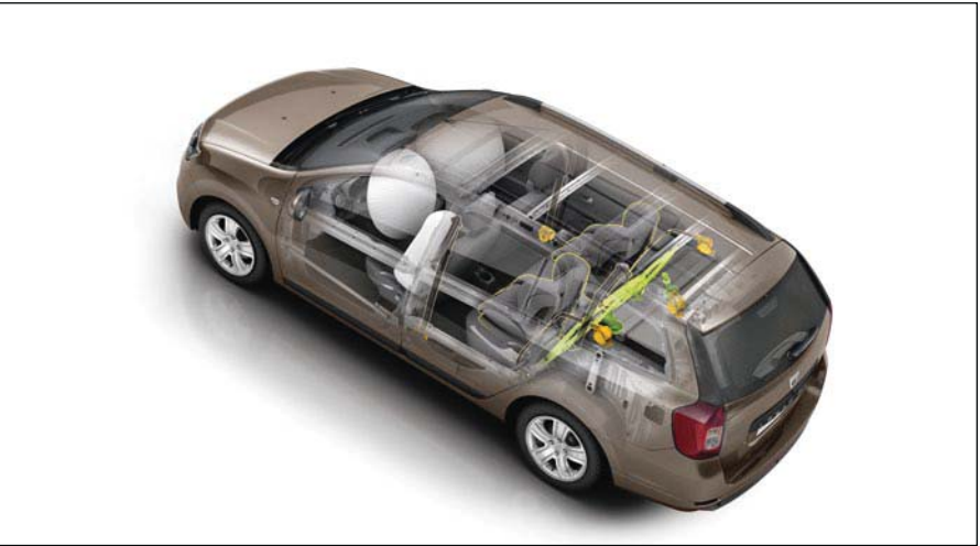
Protection des occupants : structure renforcée, airbags frontaux et latéraux avant, système de fixation ISOFIX situé au niveau des places latérales arrière.
