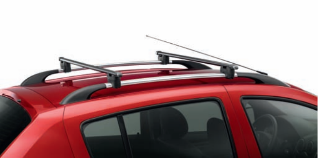
BARRES DE TOIT Les barres de toit transversales sur longitudinales permettent de transporter 80 kg de bagages ou d'installer d'autres accessoires de loisirs.
