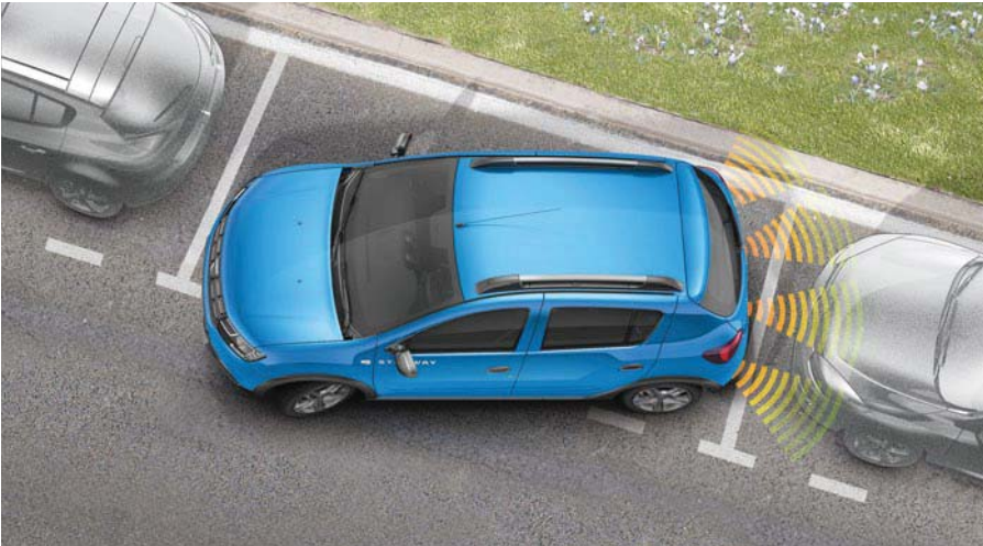
Sensori di parcheggio posteriori* : avvertono il conducente della presenza di ostacoli nella zona posteriore alla vettura con una sequenza di «bip». Per un comfort e una sicurezza ancora maggiori avete la possibilità di collegare una telecamera di retromarcia*.
