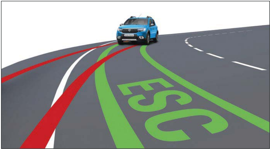
Sistema di controllo elettronico della stabilità (ESC) : consente di stabilizzare la traiettoria della vettura in caso di perdita di aderenza in curva, agendo sul ripartitore di frenata e sul regime del motore.
