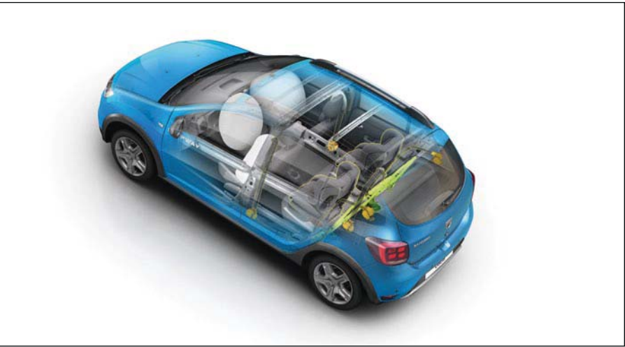
Protezione degli occupanti : struttura rinforzata, airbag frontali e laterali anteriori, sistema di fissaggio ISOFIX sui sedili posteriori laterali.
